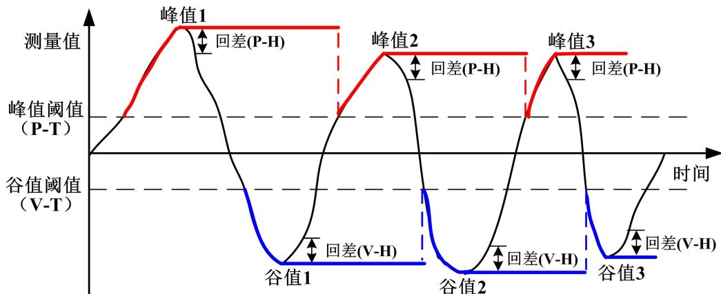
以峰值检测为例, 如上图所示, 当测量值超过峰值阈值设定值(图中P-T)后, 仪表开始检测峰值; 当测量值回落幅度超过峰值回差设定值(图中的回差即P-H)后, 仪表完成峰值检测。获取到峰值1, 峰值2、峰值3、…等获取与峰值1获取方法一样。
